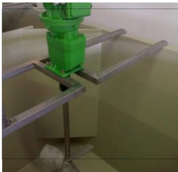
Slika 4-7 Mešalo: optimalen način vgradnje
